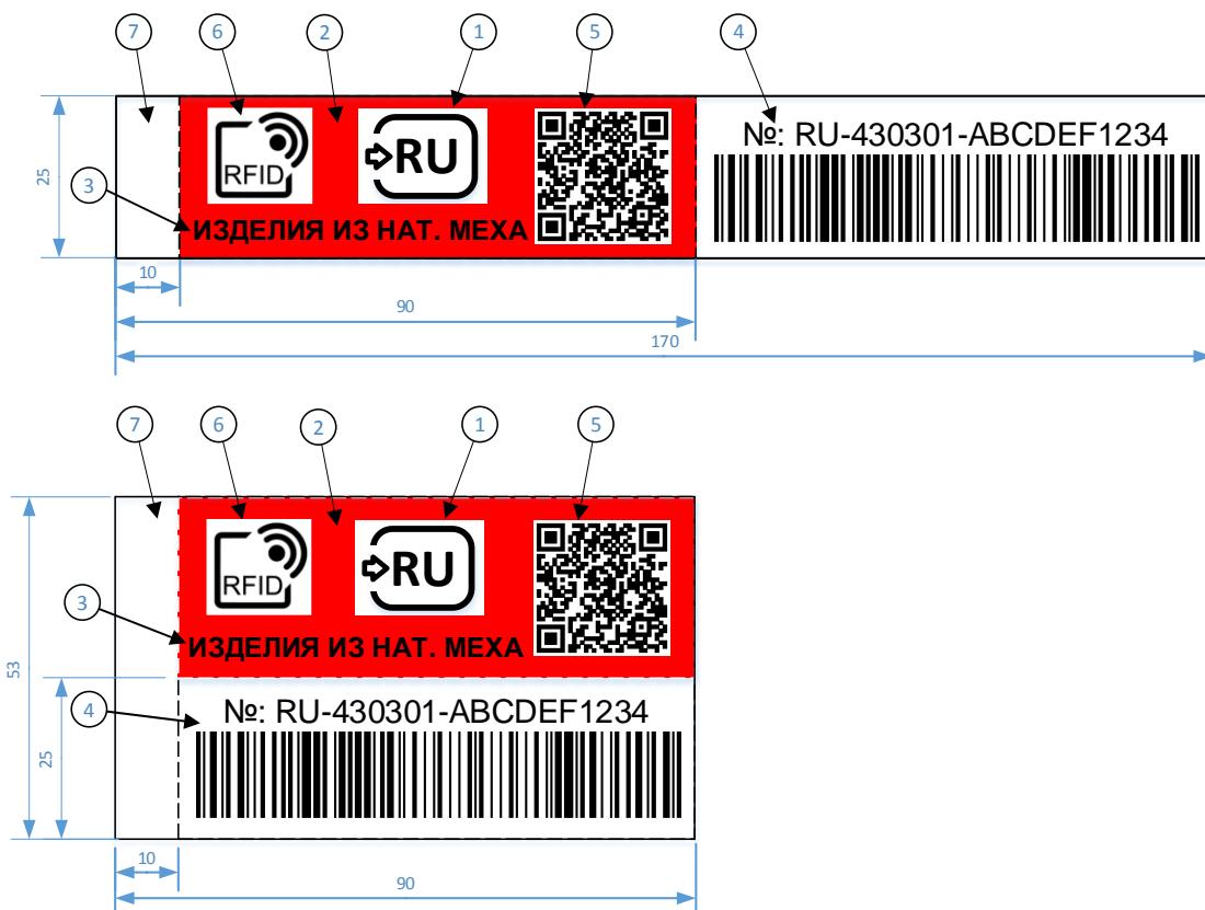
Рис 2. Пример изображения контрольного (идентификационного) знака для товаров, ввезенных на таможенную территорию Союза.
